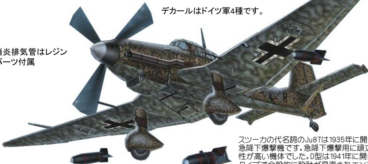
スツーカーの代名詞のJu87は1935年に開発された急降下爆撃機です。急降下爆撃用に頑丈で実用性が高い機体でした。D型は1941年に開発されたタイプで全般的に設計が見直されエンジンもより強力な物が搭載されました。D-5は主翼先端が延長され主翼の固定機銃は20mmMG151に強化されていました。大戦後半は制空権の不足で夜間爆撃が主な任務となり消炎排気管の装着やダイブブレーキの撤去など夜間戦闘に適応しています。
