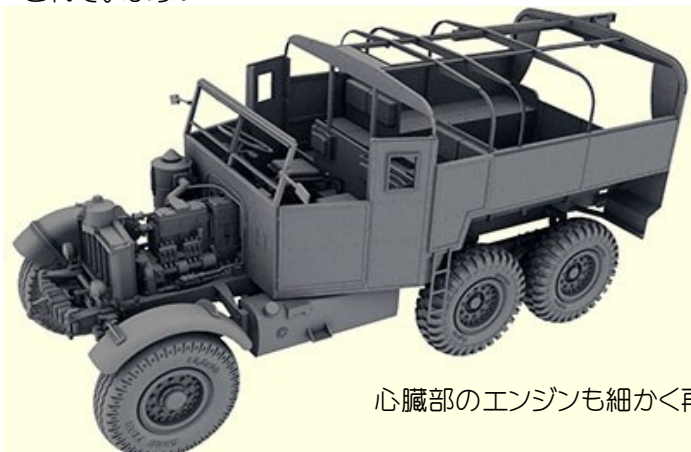
荷台下にあるウインチ装着状態がわかります。
