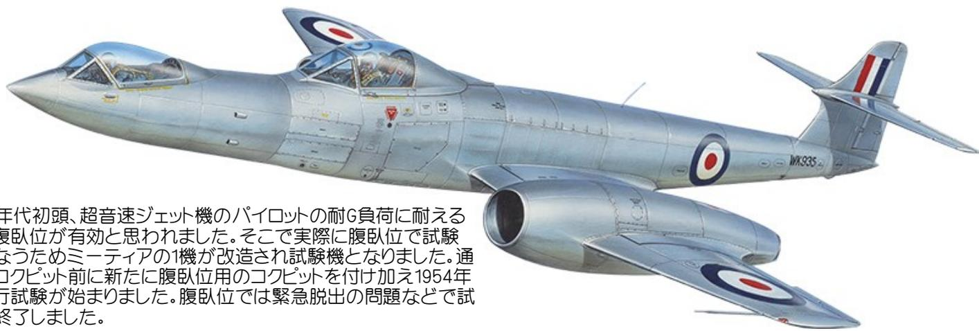
1950年代初頭、超音速ジェット機のパイロットの耐G負荷に耐えるには腹臥位が有効と思われました。そこで実際に腹臥位で試験を行なうためミーティアの1機が改造され試験機となりました。通常のコクピット前に新たに腹臥位用のコクピットを付け加え1954年に飛行試験が始まりました。腹臥位では緊急脱出の問題などで試みは終了しました。
