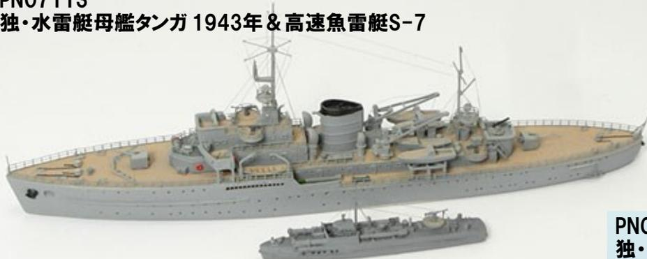
1933年就役の魚雷艇。このタイプからエンジンがディーゼルに変更された。全長32m・排水量76トン・ディーゼルエンジン3基・最大速力36ノット武装・53cm魚雷発射管2基・2cm対空砲1基
