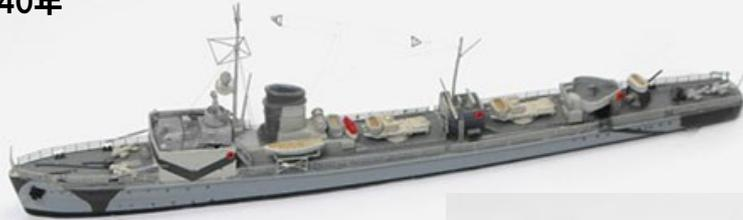
全長84m・排水量845トン・ボイラー4基タービン2基・速力35ノット53cm3連装魚雷発射管2基・10.5cm単装砲1基・2cm対空砲2基・機雷30発
