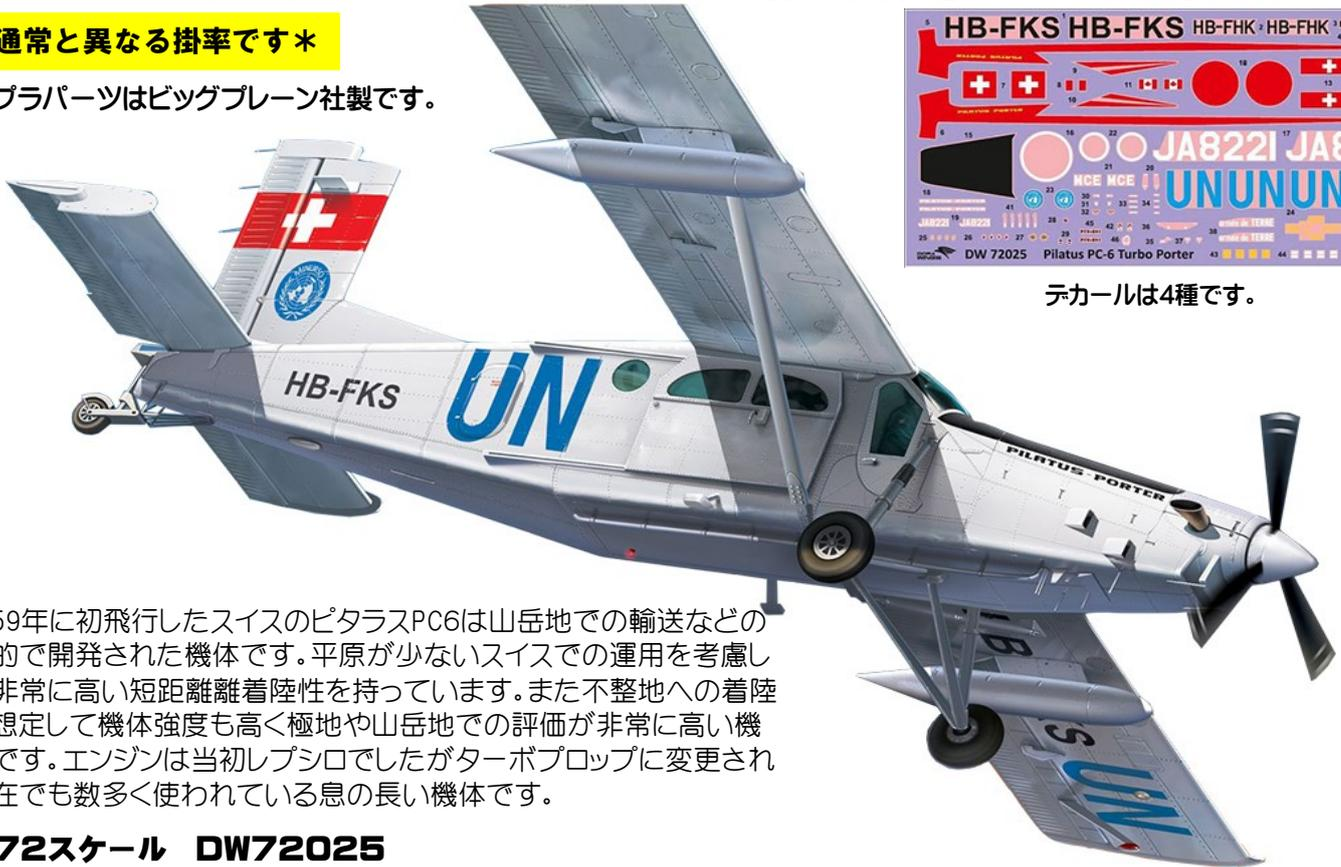
1959年に初飛行したスイスのピラタスPC6は山岳地での輸送などの目的で開発された機体です。平原が少ないスイスでの運用を考慮して非常に高い短距離離着陸性を持っています。また不整地への着陸を想定して機体強度も高く極地や山岳地での評価が非常に高い機体です。エンジンは当初レブシロでしたがターボプロップに変更され現在でも数多く使われている息の長い機体です。
