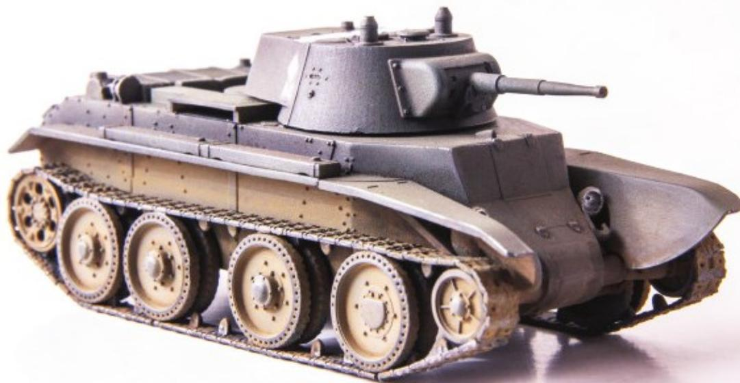
BT-7はBT-5の改良型として1935年から生産が始まりました。BT-5からの改良点は車体構造がリベット止めから溶接への変更や車体形状の変更、航続力の増加、装甲の強化などが施されました。スペイン内戦の経験から1937年からは砲塔の装甲に傾斜をつけた新型砲塔を搭載しています。ソ連では戦車にディーゼルエンジンの搭載も早くから研究されていました。1938年には戦車用V12型ディーゼルエンジンを完成させBT-7に搭載する試験が行なわれました。好成績を得たため1939年から生産が始まりディーゼル型はBT-7Mと呼ばれ、その後のソ連戦車の基礎を作りました。
