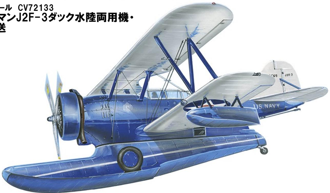
グラマン社が開発した水陸両用の汎用機です。胴体と一体化したメインフロートが特徴でフロートには収納式の車輪も装備され水陸に使えるよう設計されていました。このフロートには物資や燃料も搭載でき本機の汎用性を高める要素でもありました。第二次大戦の勃発で需要は高まり数多くの任務をこなした傑作機でした。F-3型は要人輸送型で20機が生産されました。
