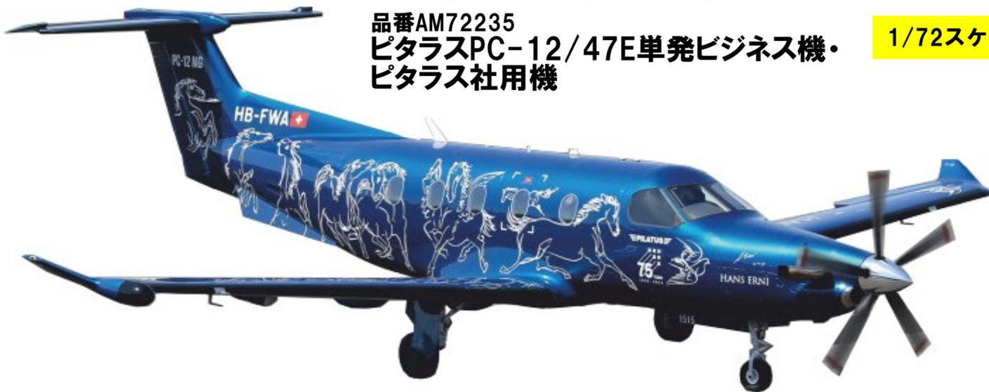
スイスのピタラス社で開発生産されているターボプロップ機です。1991年に初飛行を行い現在でも生産中です。PC-12は航空業界で新たな市場を目指し開発されています。企業の物資輸送や地方の旅客輸送などで単発ターボプロップ機としては高い占有率を持っています。2019年時点では1700機もの機体が運用されています。信頼性の高いエンジンや与圧されたキャビン、STOL性や荒れた滑走路でも対応できる柔軟性などで多くの顧客を魅了しています。PC-12/47Eは2008年に発表されたタイプです。エンジンを強化しアビオニクスも新型となっています。
