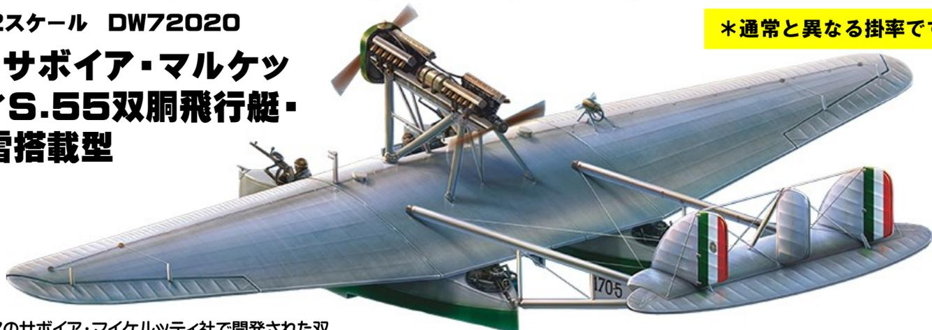
イタリアのサボイア・マルケッティ社で開発された双胴の飛行艇です。胴体上の主翼には中央にエンジンがプッシュプル方式で搭載され、操縦席は翼内に設けられていました。軍用型は双胴の胴体部には前後に銃座が設けられ、魚雷は両胴体の間の翼下面に装備されました。
